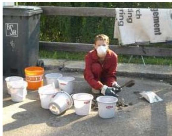
**Abb. 3: links: Einengen der Fraktion < 40 mm, rechts: Klaubanalyse der Fraktion < 40 mm**
